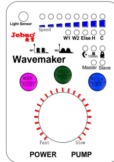
Рис. 3: Панель управления контроллера
